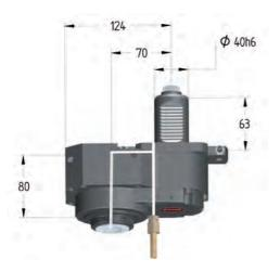
Осевые инструментальные головки с внешней и внутренней подачей СОЖ
