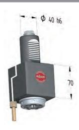
Осевые инструментальные головки с внешней подачей СОЖ Для установки зажимных цанг ER по DIN 6499, хвостовик VDI с фиксацией от проворота шпинделя (лицензия фирмы Sauter), предохранительная зажимная гайка АХ с наружной резьбой REGIO-FIX
