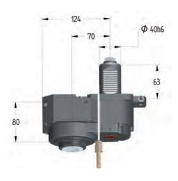
Осевые инструментальные головки с внешней подачей СОЖ Для установки зажимных цанг ER по DIN 6499, хвостовик VDI с фиксацией от проворота шпинделя (лицензия фирмы Sauter), предохранительная зажимная гайка АХ с наружной резьбой REGIO-FIX, смещение осей
