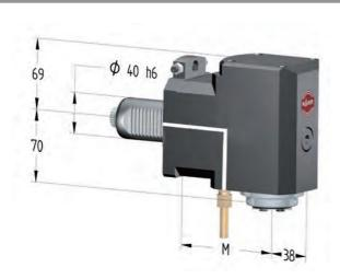
Радиальные инструментальные головки с внешней подачей СОЖ Для установки зажимных цанг ER по DIN 6499, хвостовик VDI с фиксацией от проворота шпинделя (лицензия фирмы Sauter), предохранительная зажимная гайка АХ с наружной резьбой REGIO-FIX
